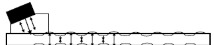
Lamb wave : symmetrical mode
