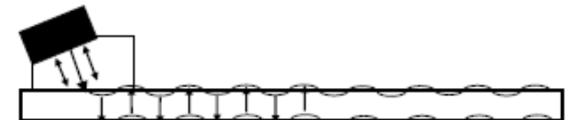
Lamb wave : antisymmetrical mode
